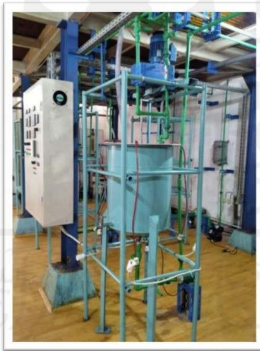
Gambar 2. Unit Pelindian Ekstraksi Zirkon
