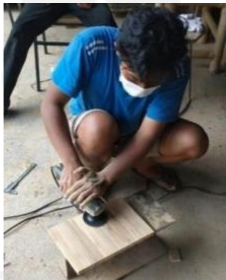
Gambar 4. 2 Proses Pengampelasan dengan Gerinda tangan
