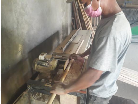
Gambar 4. 23 Ujicoba pengampelasan dengan batang bambu
