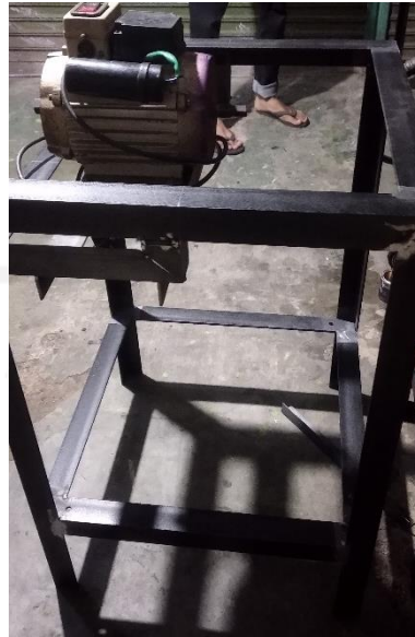
Gambar 4. 18 Pembuatan Rangka Mesin Disc Sander
