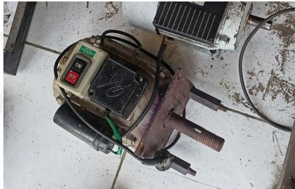
Gambar 4. 5 Motor Induksi yang digunakan
