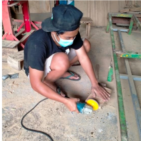
Gambar 4. 26 Proses pengamplasan dengan menggunakan Gerinda Tangan
