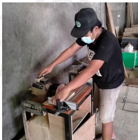
Gambar 4. 27 Proses pengamplasan menggunakan mesin Disc Sander
