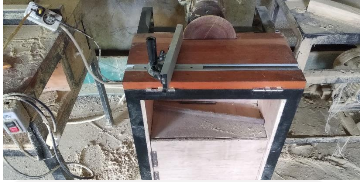
Gambar 4. 21 Pembuatan Penyimpanan mesin Disc Sander
