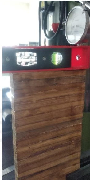
Gambar 4. 25 Kalibrasi kerataan produk sebelum dilakukan pengukuran
