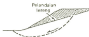
Gambar 3. 4 Tipe Keruntuhan Lereng Gabungan
