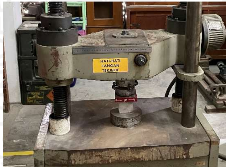
Gambar L-3.4 Pengujian Kuat Tekan
