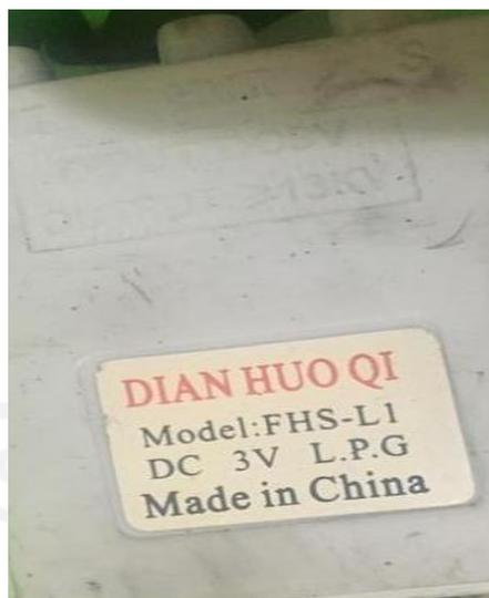
Gambar 4- 15 Pengontrol pematik api
