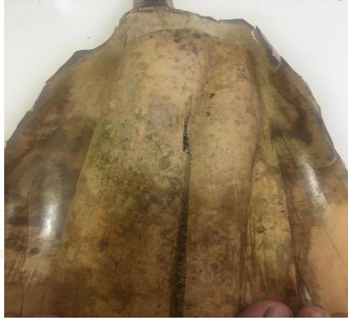
Gambar 4- 19 Proses posisi pengepresan dua pelepah vertikal/sejajar
