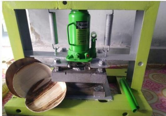
Gambar 3- 2 Alat Cetak Piring dari Pelepah Pinang
