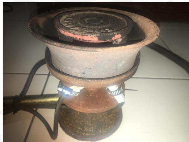
Gambar 4- 14 Tungku api dengan pematik otomatis
