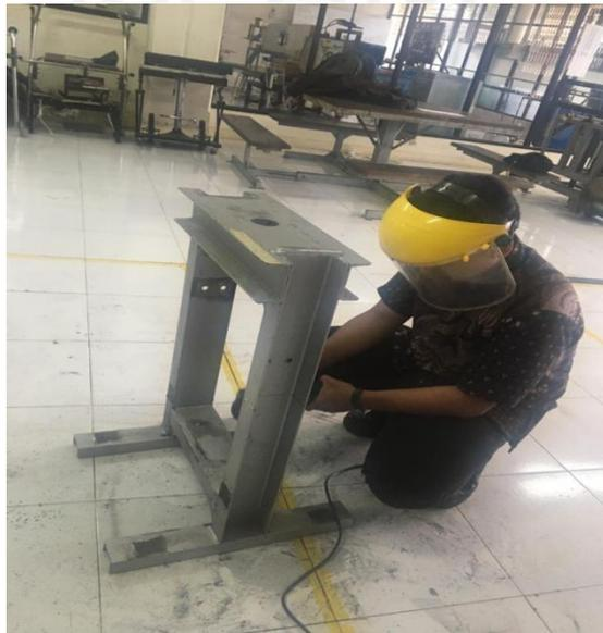
Gambar 4- 6 Proses Pemotongan Besi UNP10
