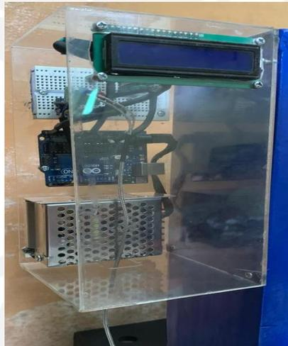
Gambar 3- 12 Perangkaian *Termocouple type K* dan LCD
