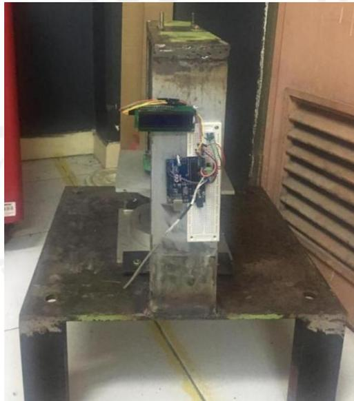
Gambar 4- 11 Pemasangan Posisi *contoller* dan LCD
