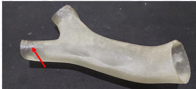
Gambar 4- 34 Endapan Resin Pada Support Abdominal Aorta Normal
