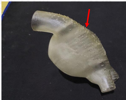
Gambar 4- 35 Endapan Resin Pada Support Abdominal Aortic Aneurysm
