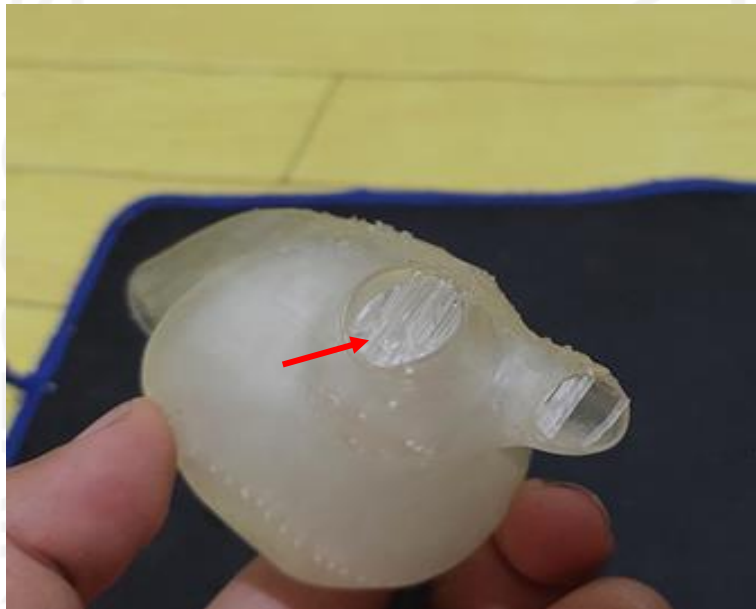
Gambar 4- 37 Support Dibagian Dalam Abdominal Aortic Aneurysm
