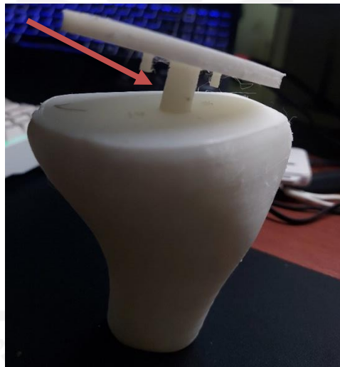
Gambar 4-18 Hasil percobaan pertama tidak bisa assembly
