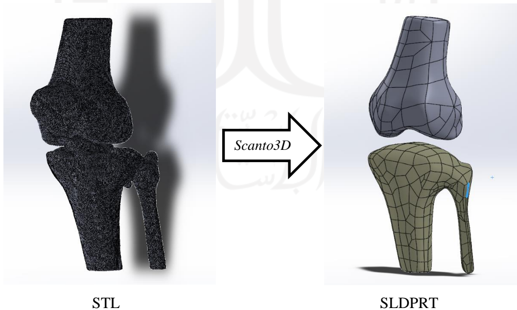
Gambar 3-5 Convert STL ke solid body
