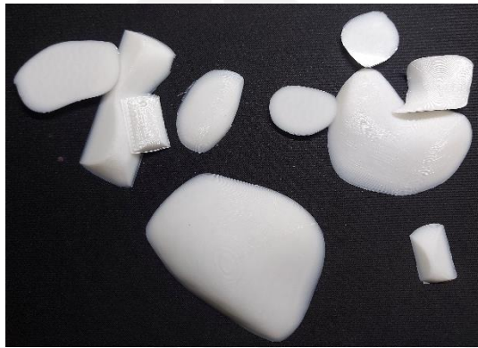
Gambar 4-15 Hasil 3D print potongan tulang lutut
