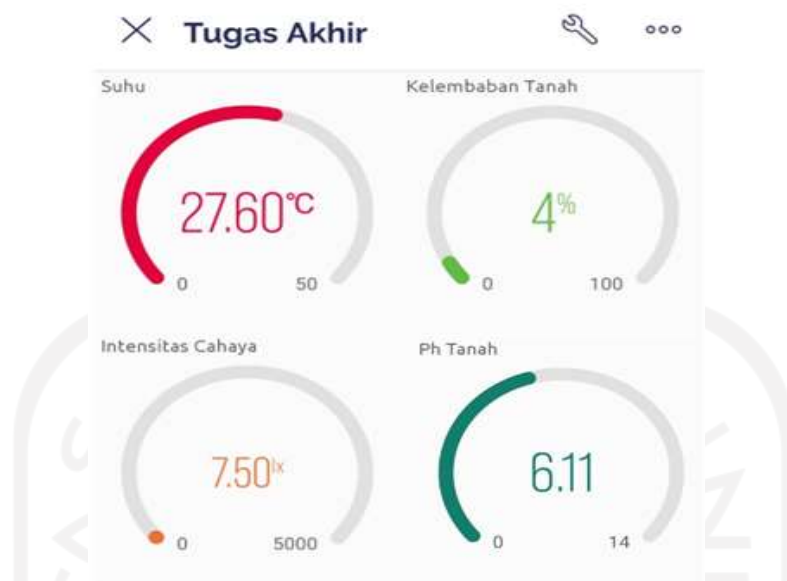
Gambar 4.7 Tampilan aplikasi blynk penerapan internet of things (iot) pada greenhouse
