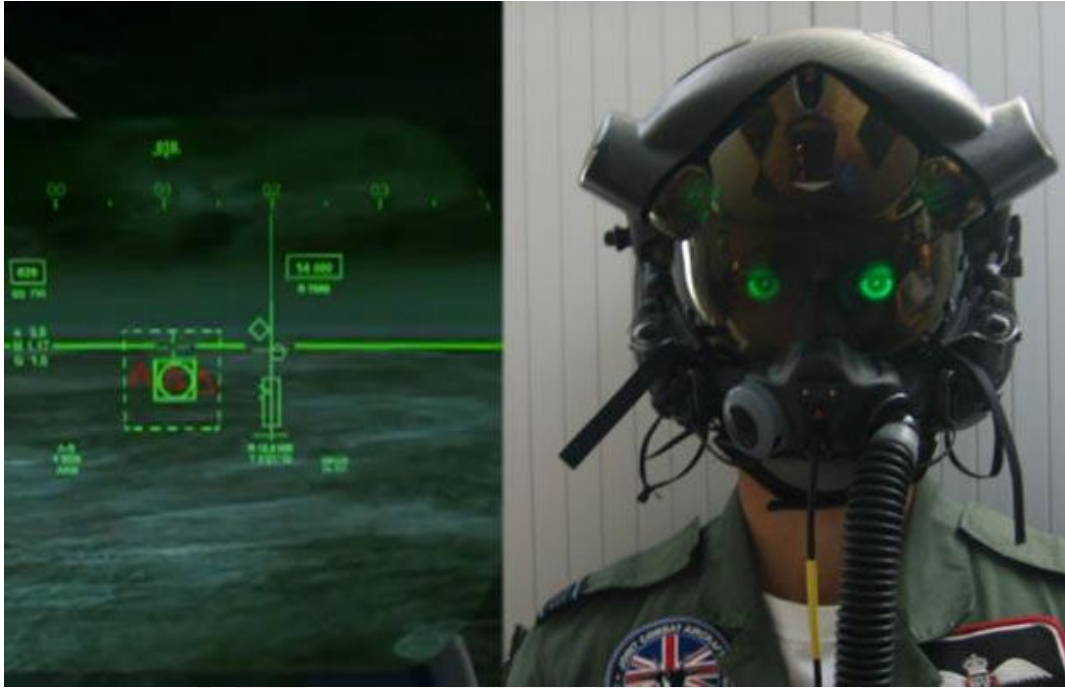
Gambar 2.2 Tampilan helm dan HUD yang digunakan pilot militer
