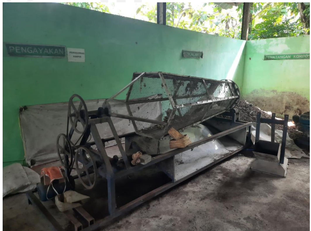
Lampiran 7. Mesin pengayak yang tersedia di TPS 3R Kenanga Merdiko
