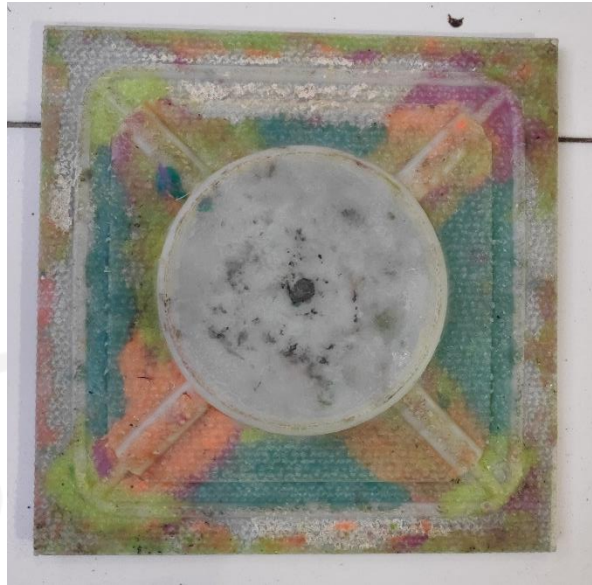
Gambar 4- 16 Soft Mold Tampak Atas
