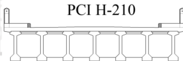
Gambar 5.1 Jembatan HKSJN Menggunakan PCI-Girder H-210cm
