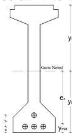
Gambar 5.19 Posisi Tendon di Tengah Bentang
