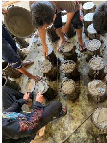
Gambar L-3.6 Proses Pencetakan dan Pematatan
