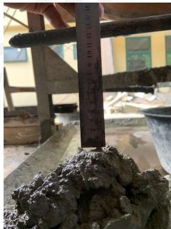
Gambar L-3.6 Pengujian Nilai Slump
