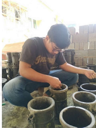
Gambar L-3.1 Pelumasan Pada Cetakan Silinder
