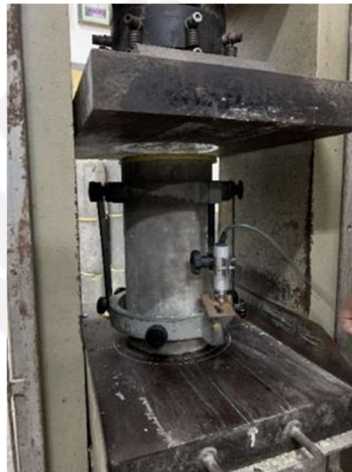
Gambar L-3.10 Proses Pengujian Kuat Tekan dan Modulus Elastisitas Beton
