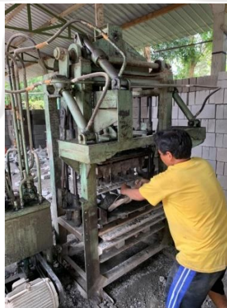
Gambar 4.17 Proses Pembuatan Paving Block
