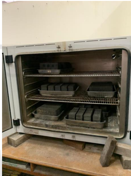
Gambar L-9.11 Proses Pengeringan Paving Block Menggunakan Oven
