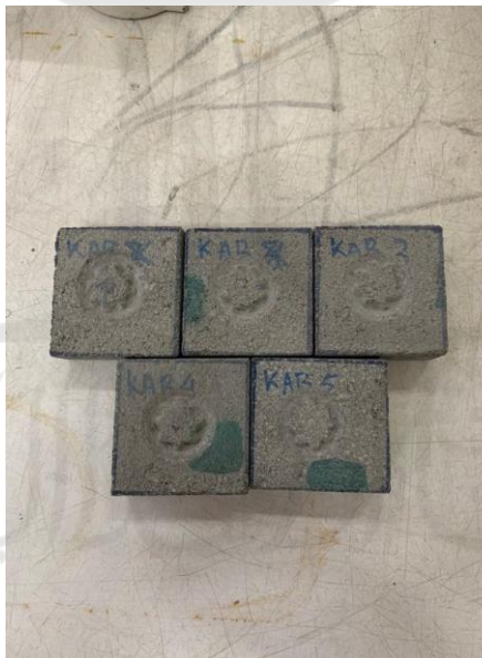
Gambar L-9.16 Paving Block Variasi 5% Setelah Pengujian Ketahanan Aus
