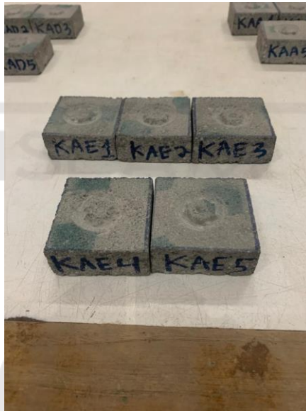
Gambar L-9.19 Paving Block Variasi 20% Setelah Pengujian Ketahanan Aus
