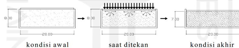
Gambar 3.4 Prinsip Kerja Metode Mekanis (Sumber: Pamungkas & Hairunnisa, 2007)
