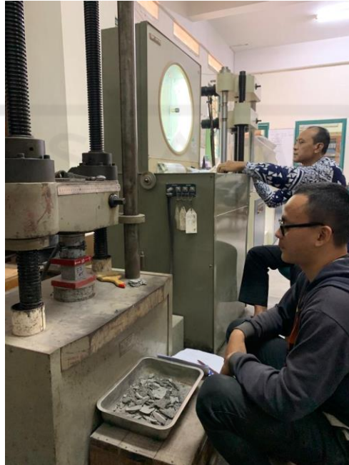
Gambar L-9.1 Proses Pengujian Kuat Tekan
