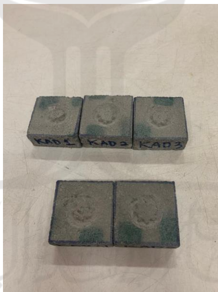
Gambar L-9.18 Paving Block Variasi 15% Setelah Pengujian Ketahanan Aus
