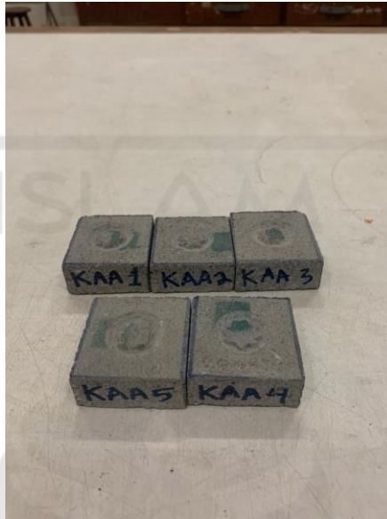
Gambar L-9.15 Paving Block Variasi 0% Setelah Pengujian Ketahanan Aus
