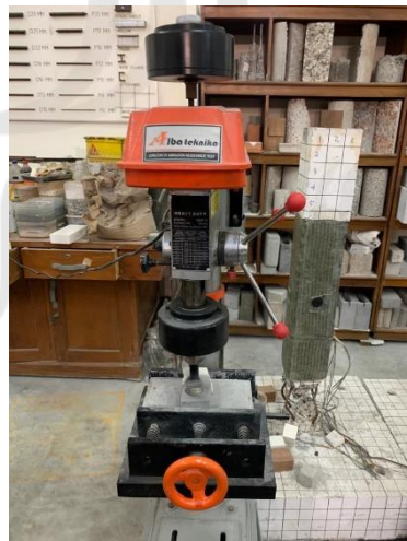
Gambar 4.14 Mesin Uji Ketahanan Aus
