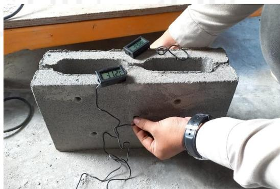
**Gambar L 4.3 Pengecekan Suhu menggunakan Thermometer**
