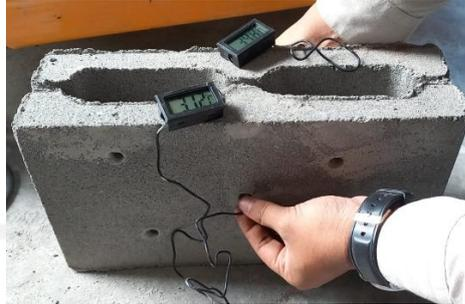
**Gambar 4. Pengujian Proses Redaman Panas**
