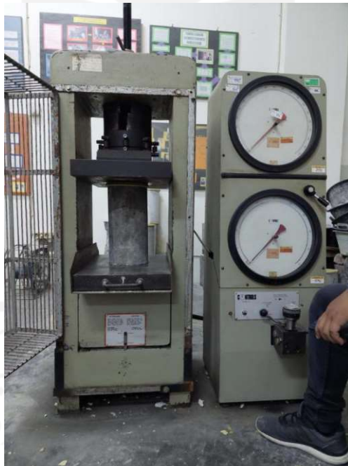
Gambar L-3.8 Pengujian Kuat Tekan
