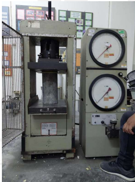
Gambar 3.1 Pengujian Kuat Tekan Beton
