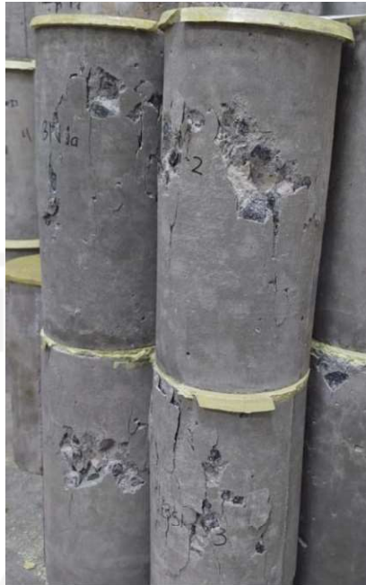
Gambar L-3.9 Hasil Pengujian Kuat Tekan
