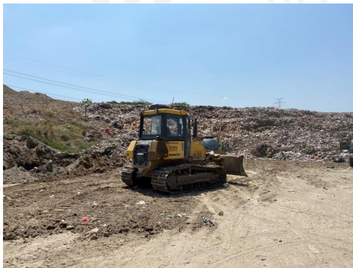
Gambar 4.16 Satu Unit Alat Berat Jenis Bulldozer Yang Sedang Melakukan Perataan Sampah di TPA Troketon Pedan Sumber : Dokumentasi Pribadi, 2021
