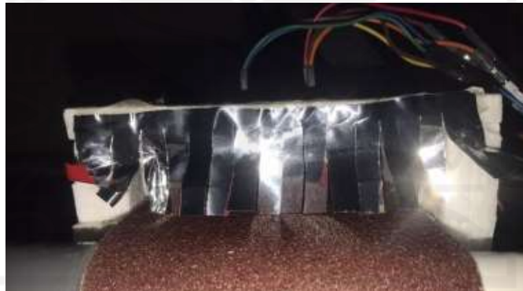
Gambar 4.4 Desain penutup bagian depan sensor
