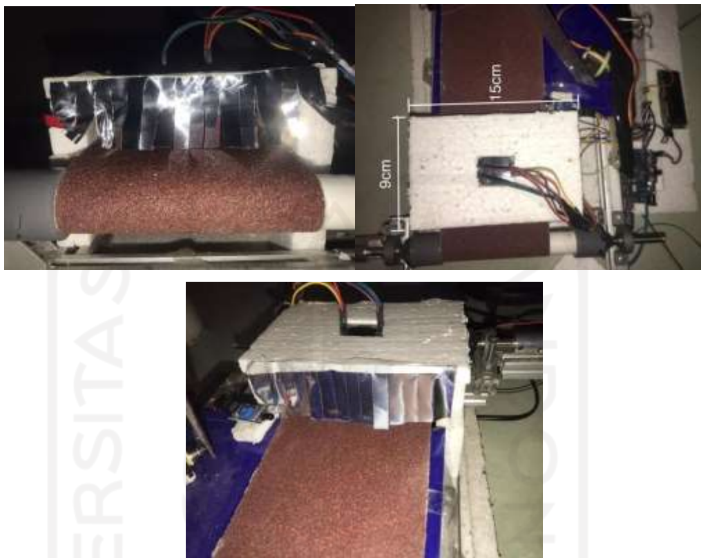
Gambar 5.2 Desain letak sensor warna tertutup
