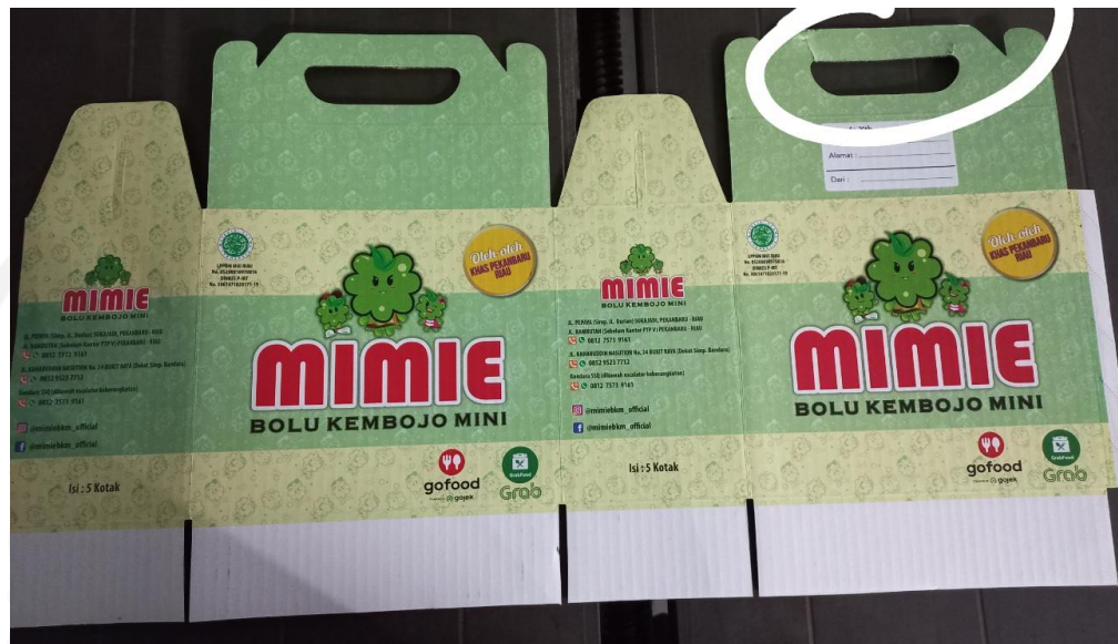
Gambar 30. Salah Pemotongan Pada Pond
