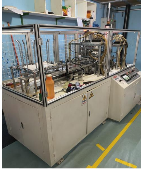
Gambar 22. Proses Pengeleman Menggunakan Mesin Forming
