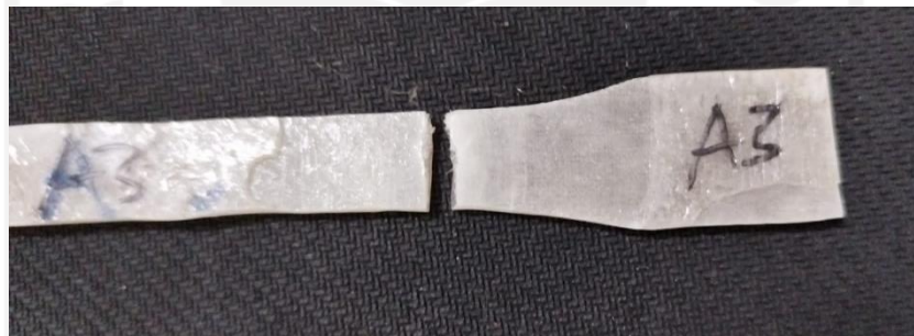
Gambar 4 - 31 Bentuk patahan pada spesimen
