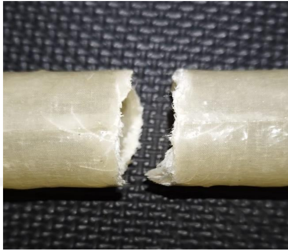
Gambar 4 - 27 Patahan pada spesimen bending
