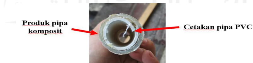
Gambar 4 - 21 Pipa komposit yang tidak dapat di lepaskan
