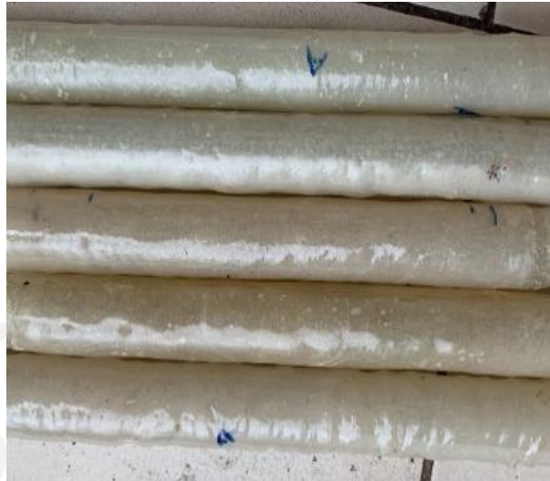
Gambar 4 - 24 Spesimen Uji Bending Pipa Komposit Sebelum Pengujian
