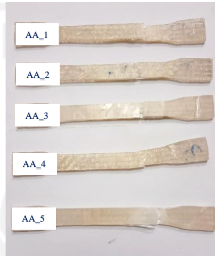
Gambar 4 - 32 Spesimen setelah pengujian tarik
