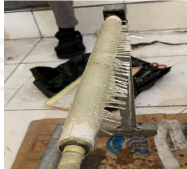
Gambar 4 - 24 Spesimen serat kaca anyam yang terbuka
