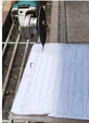
Gambar 4 - 23 Pemotongan spesimen uji tarik
