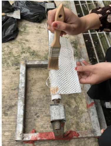
Gambar 4 - 8 Pemasangan serat kaca anyam
