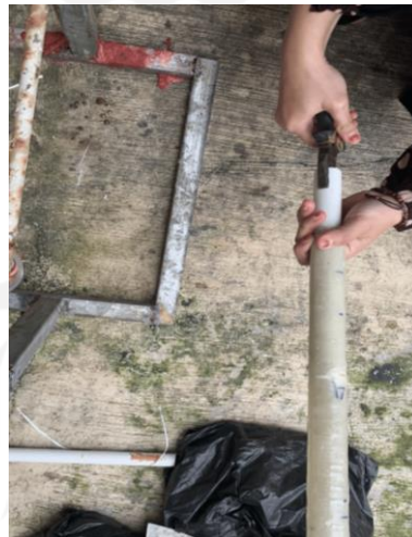
Gambar 4 - 11 Pelepasan spesimen dari cetakan
