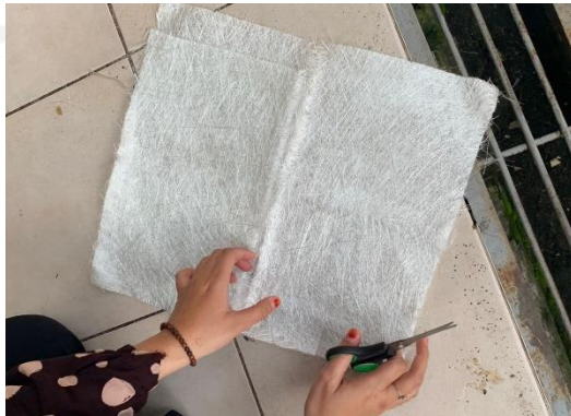
Gambar 4 - 15 Pemotongan serat kaca acak
