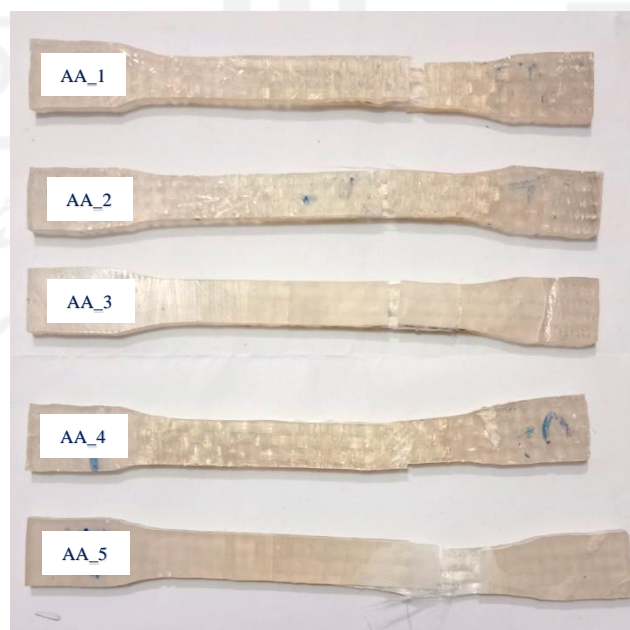
Gambar 4 - 36 Jenis patahan pada pengujian tarik
