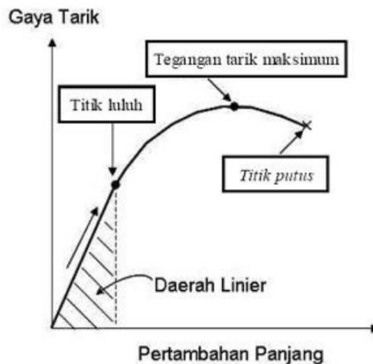
Gambar 2 - 11 Grafik tegangan – regangan (Sumber: Sunaryo, adhitya dkk., 2014)
