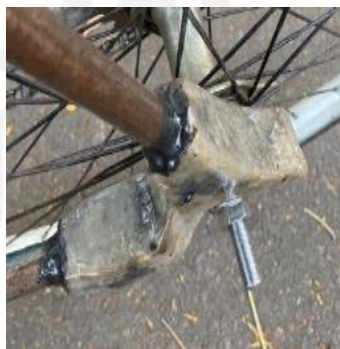
Gambar 4- 34 Dropout yang sudah terpasang
