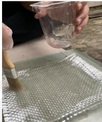
Gambar 4 - 15 Proses Pemasangan Fiberglass Serat Anyam
