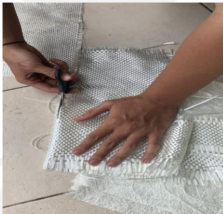
Gambar 4 - 11 Proses Pemotongan Serat Anyam
