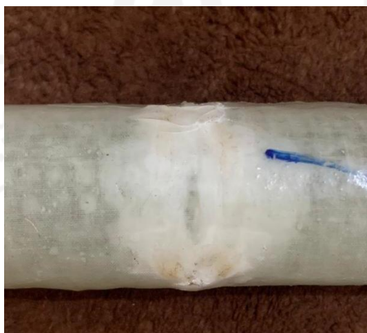
Gambar 4 - 20 Patahan Spesimen Bending 1
