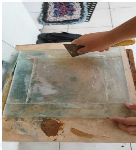
Gambar 4 - 17 Pelepasan Spesimen Dari Cetakan
