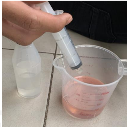
Gambar 4 - 14 Pencampuran Resin dan Katalis.
