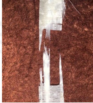
Gambar 4 - 22 Spesimen Patah Getas
