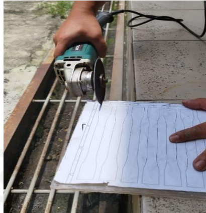
Gambar 4 - 18 Proses pemotongan Spesimen Uji
