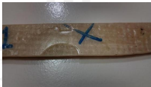
Gambar 4 - 25 Spesimen Kurang Merata.
