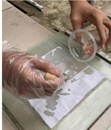
Gambar 4 - 16 Proses Pemasangan Kain Mori
