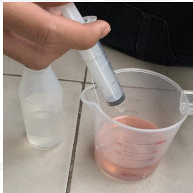
Gambar 4 - 5 Pencampuran Resin dan Katalis
