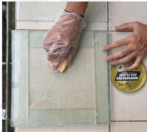
Gambar 4 - 13 Pemasangan Wax Release
