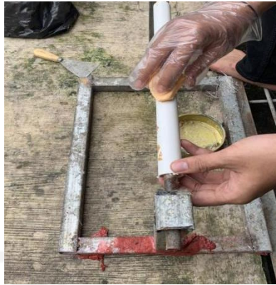
Gambar 4 - 4 Proses Pelapisan Dengan Wax Release
