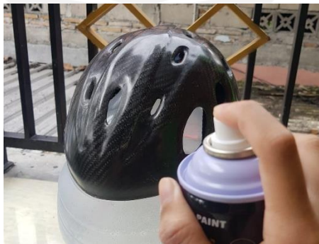
Gambar 4-20 Penyemprotan clear gloss pada permukaan produk
