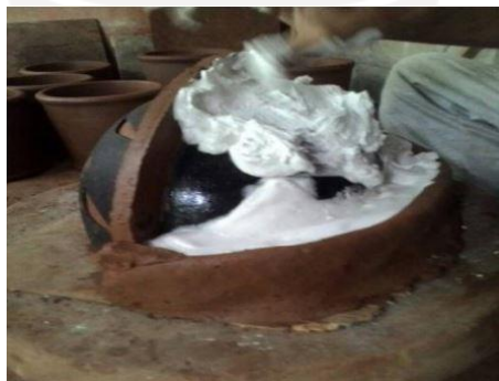
Gambar 2-1 Pembuatan cetakan helm secara manual
