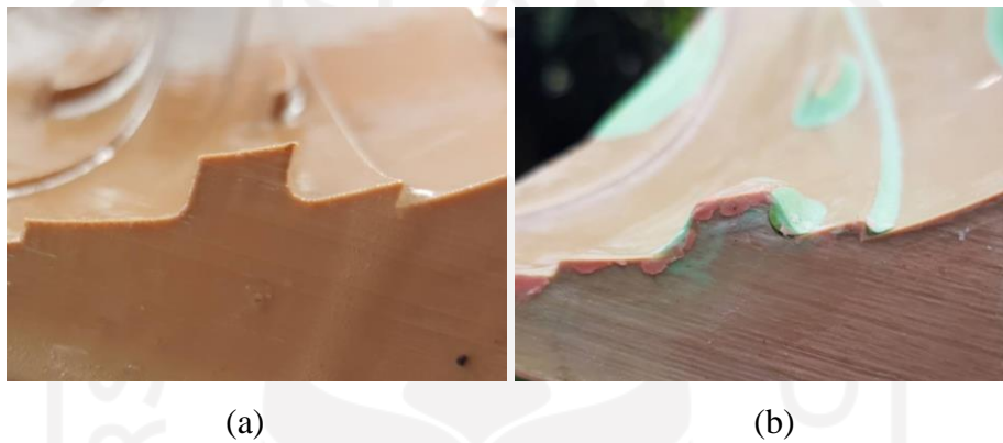
Gambar 4-26 a) Cetakan sebelum di dempul; b) Cetakan setelah di dempul
