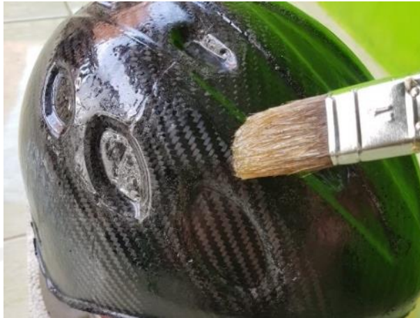
Gambar 4-19 Pengolesan resin pada permukaan produk
