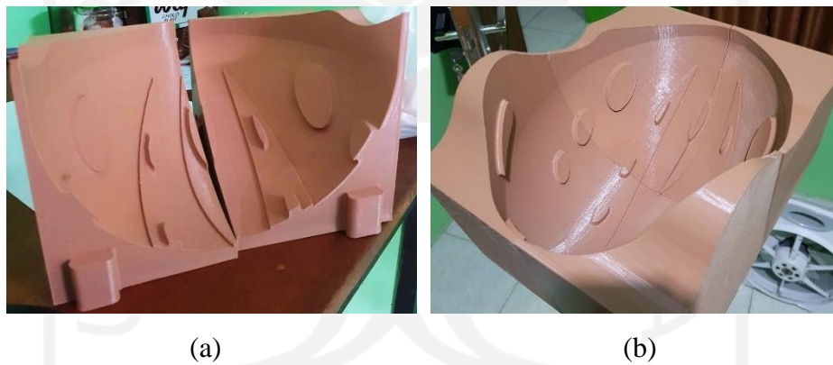
Gambar 4-10 Hasil print a) Cetakan bagian 1a-1b; b) Cetakan utuh
