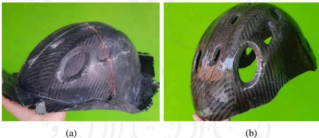
Gambar 4-18 a) Produk hasil vacuum infusion ; b) Produk setelah pemotongan
