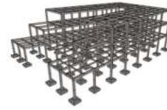
Struktur bangunan ini menggunakan material beton rtulang. Pada sistem struktur modular dengan modul ukuran 6 x 6 atau 36 m<sup>2</sup>, sebagaimana ketentuan kolom ukuran 50 cm x 50 cm dan balok induk 30 cm x 50 cm.
