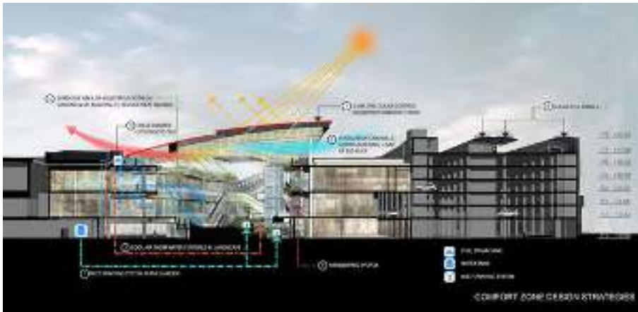
Gambar 2.17 Sistem Penghawaan dan Utilitas Sumber: archdaily.com
