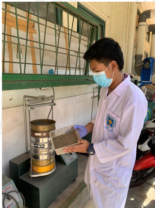
Gambar 4. 7 Proses Uji Gradasi Butiran
