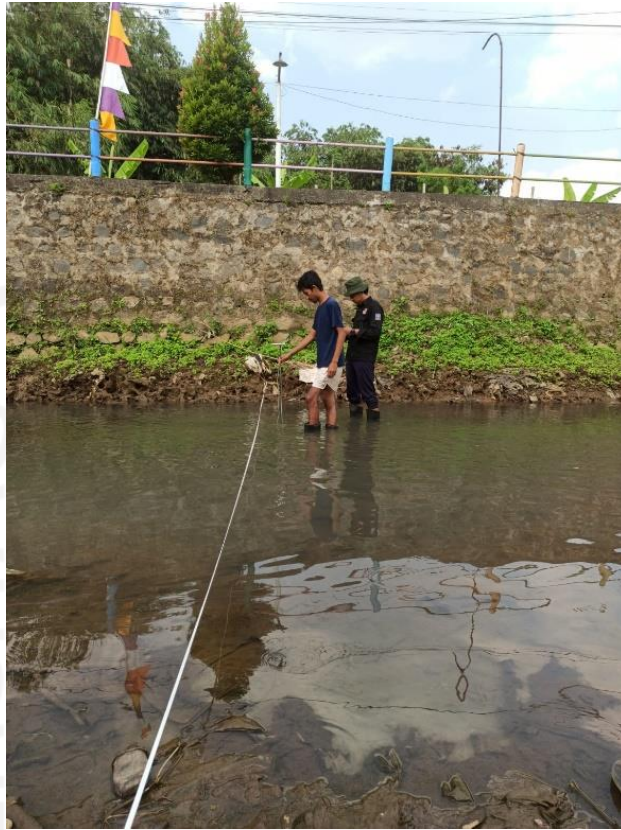
Gambar 4. 2 Pengukuran lebar dan kedalaman sungai Panjang
