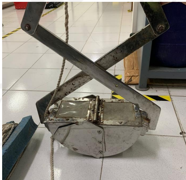
Gambar 3. 4 Alat Pengumpul Sedimen tipe Ekman Grab model Besi
