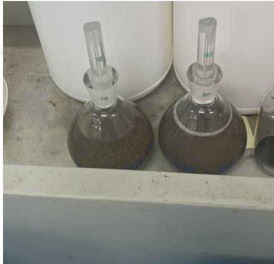
Gambar 4. 10 Proses pengujian berat jenis dengan piknometer
