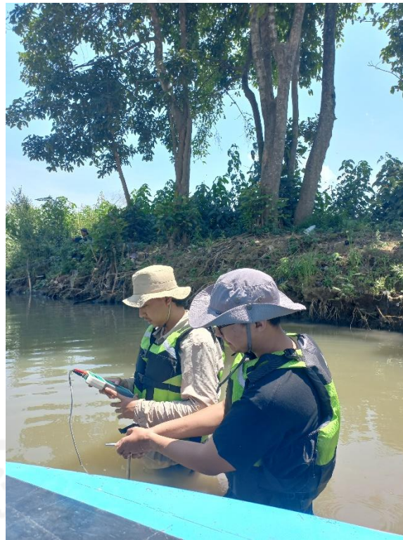
Gambar 4. 1 Pengambilan data kecepatan aliran Sungai Panjang
