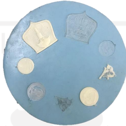
Gambar 3. 22 Penempatan Master Cetakan pada Silicone rubber
