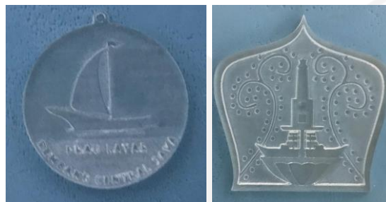
Gambar 4. 5 Master Cetakan dari Pemesinan CNC
