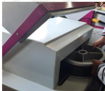
Gambar 3. 26 Memasukkan Cetakan kedalam Mesin Vulkanisir
