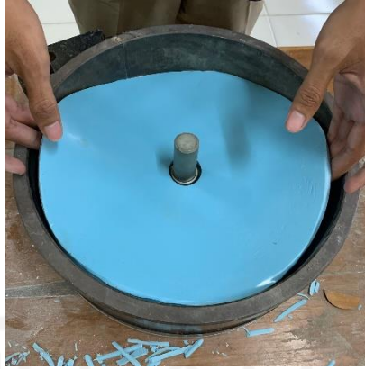
Gambar 3. 24 Memasang Silicone rubber Bagian Atas
