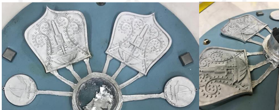
Gambar 4. 8 Hasil Pengecoran Spin casting percobaan pertama
