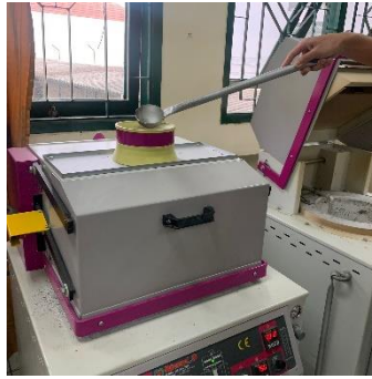
Gambar 3. 28 Proses penuangan Material Zinc ke Mesin Spin casting
