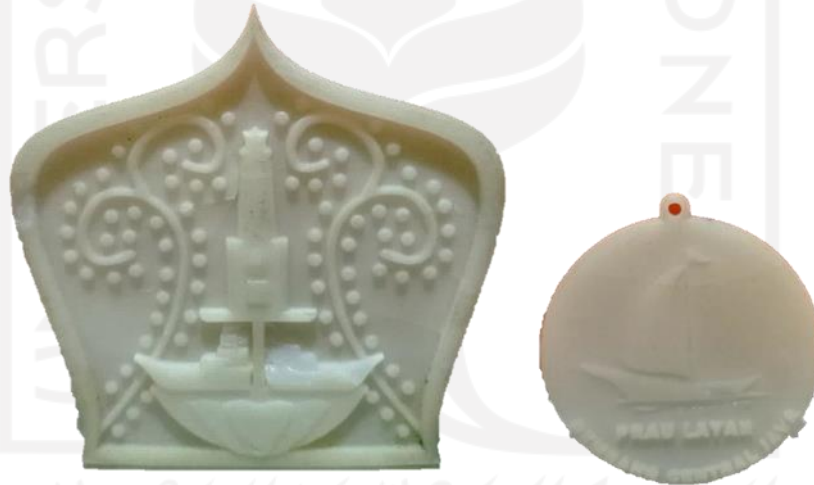
Gambar 4. 7 Master Cetakan setelah Vulkanisir
