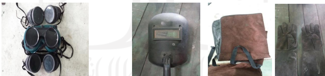
Gambar 4.9 Alat Keselamatan Pada Proses Pengelasan SMAW
