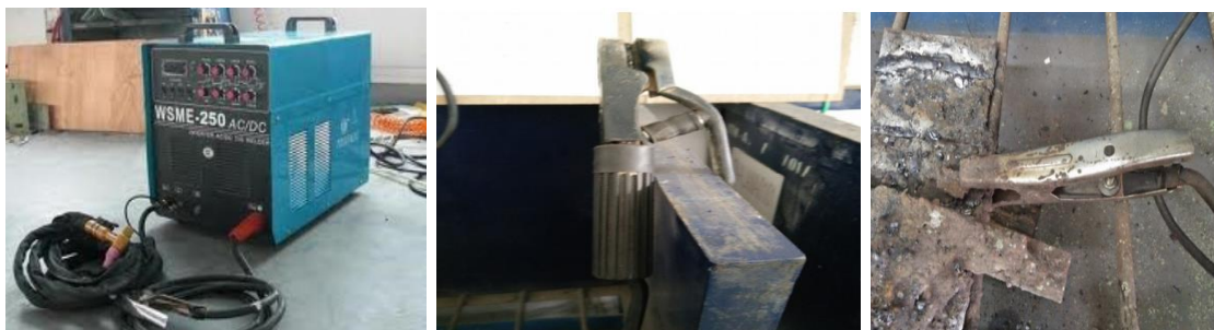
Gambar 4.7 Alat Utama Proses Pengelasan SMAW
