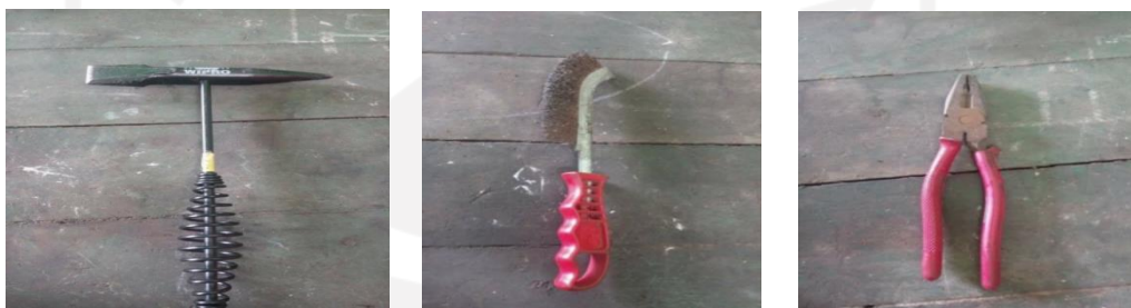
Gambar 4.8 Alat Bantu Pada Proses Pengelasan SMAW
