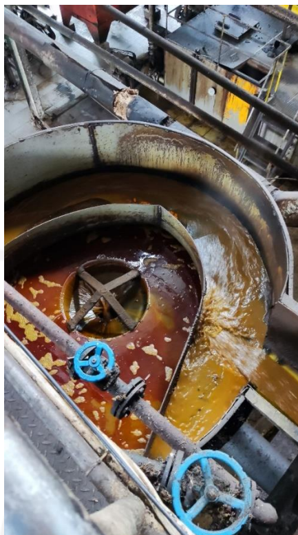
Gambar 4. 12 Proses air mengalir dari stasiun press menuju klarifikasi
