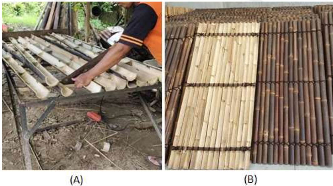
Gambar 1.1 Proses Pembuatan Takik Bambu Secara Manual (A), Panel Bambu yang Telah Dirakit (B)
