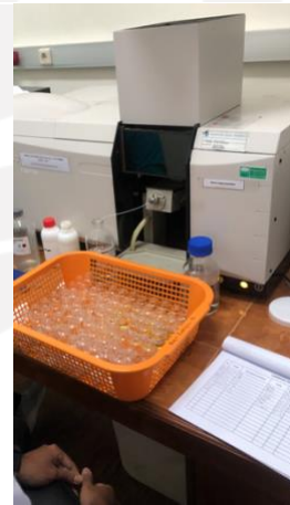
Gambar 8 Analisa logam berat menggunakan instrumen
