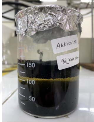
Proses aktivasi arang ampas kopi dengan HCl 0,1 M selama 48 jam
