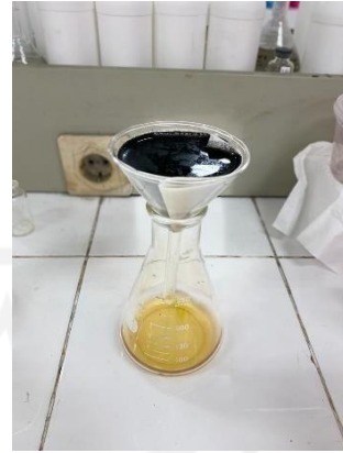
Proses penetralan arang aktif ampas kopi dengan menggunakan aquadest hingga pH 6
