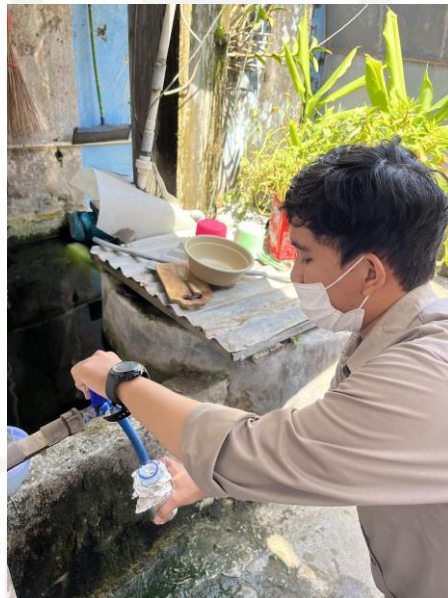
Gambar 3. 4 Pengambilan sampel air sumur melalui keran
