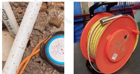
Gambar 3. 3 Pengukuran dengan Altimeter dan Water Level Meter
