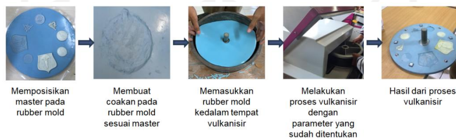
Gambar 4. 8 Skema proses vulkanisir
