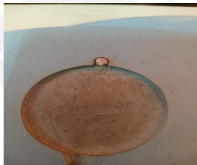
Gambar 4. 15 Penambahan Rubber Silicone Pada Mold
