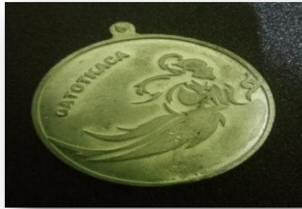
Gambar 4. 14 Kendala Hasil Produk dengan Master Cetakan 3D Print Resin
