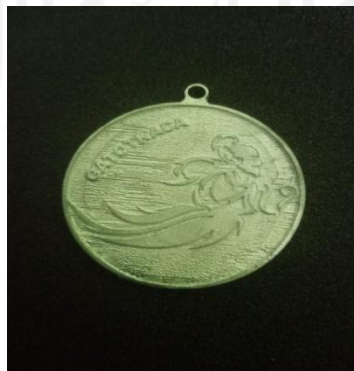
Gambar 4. 16 Kendala Hasil Produk dengan Master Cetakan Laser Cutting
