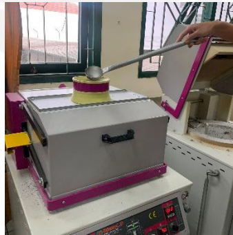
Gambar 3. 31 Proses penuangan Zinc ke mesin Spin Casting
