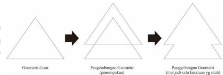
Gambar 2.31 Geometri Atap Rumah Adat Baloy Mayo
