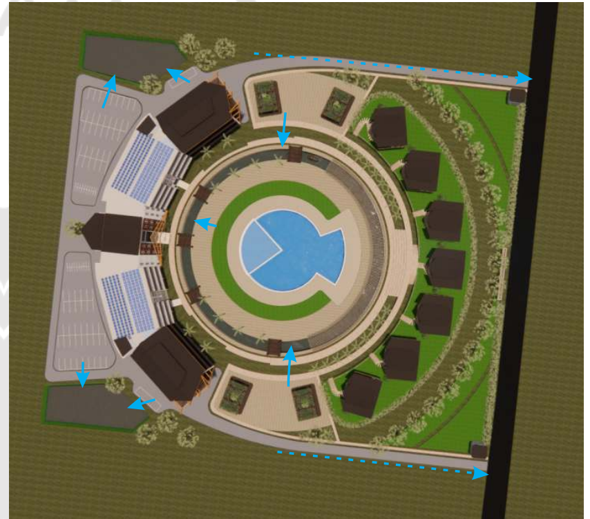
Gambar 3.17 Skema Aliran Air Hujan Sumber : Penulis, 2022
