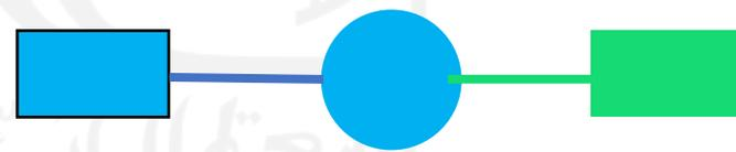
Air hujan dan air kotor sisa makanan masuk kedalam selokan air, lalu diendapkan pada bak kontrol lemak setelah itu menuju pada sumur resapan dan diresapkan melalui pipa-pipa air berupa drainase berporus.
