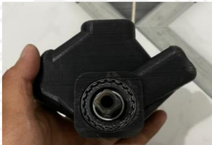
Gambar 4-52 Sambungan bottom bracket PLA
