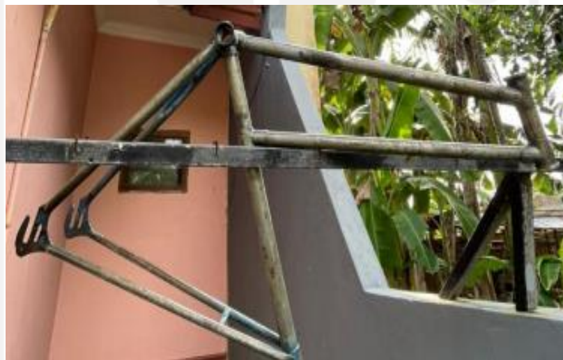
Gambar 4-1 Kondisi frame setelah proses pembersihan cat
