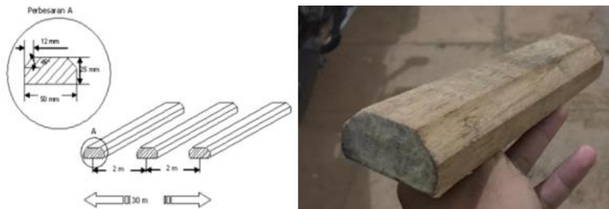
Gambar 4-45 Spesifikasi balok uji
