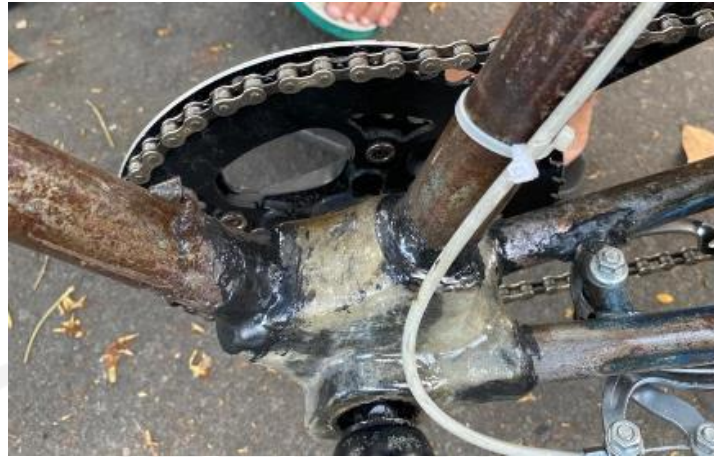
Gambar 4-51 Penggunaan pipa asli sepeda jengki
