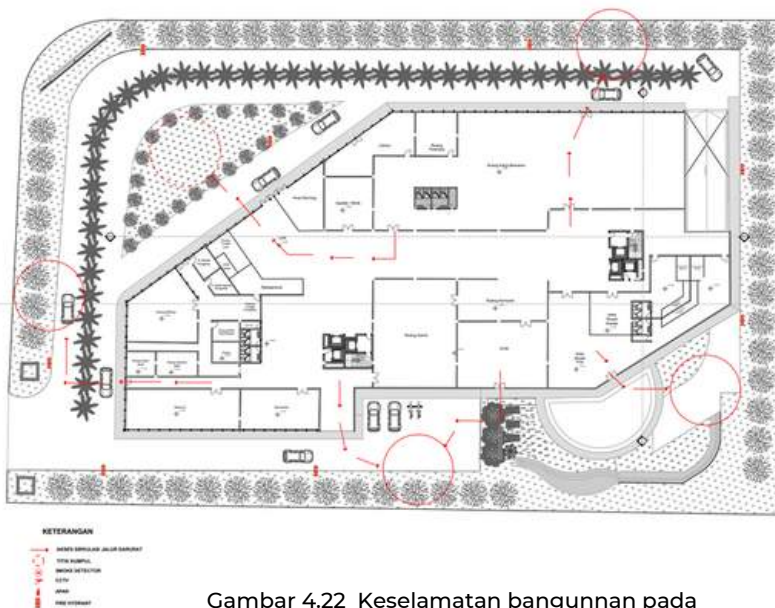
Gambar 4.22 Keselamatan bangunan pada lantai GF
