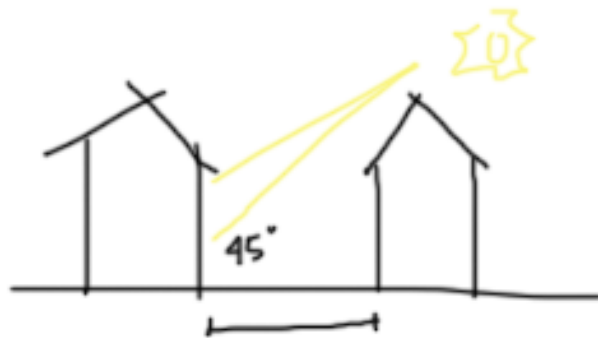
Gambar 3.34 Skema Jarak Antar Bangunan terhadap Cahaya Matahari Sumber: Penulis, 2022
