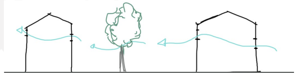
Gambar 3.36 Skema Cross Ventilation Sumber: Penulis, 2022
