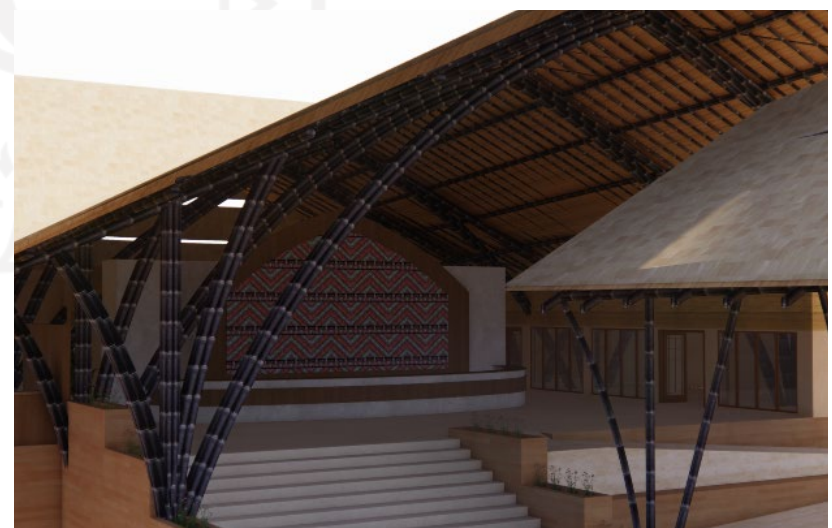
Gambar 3.42 Penggunaan Bambu Pada Struktur Sumber: Penulis, 2022
