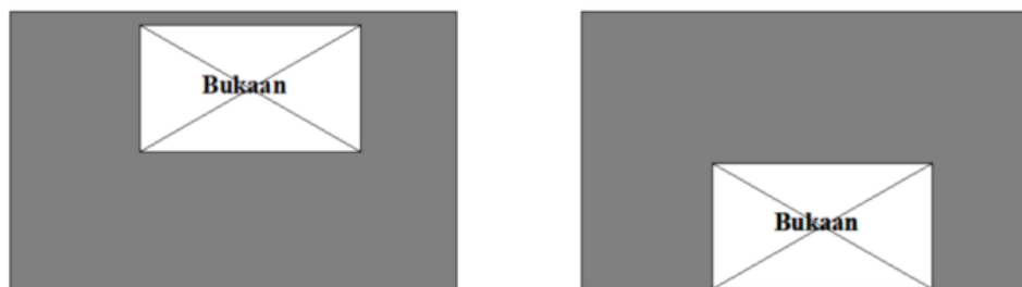
Gambar 3.10 Ketidakteraturan Diskontinuitas Diafragma
