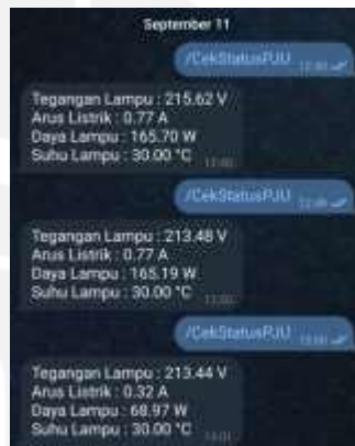
Gambar 4.2 Hasil Monitoring pada Telegram untuk percobaan 3 buah lampu
