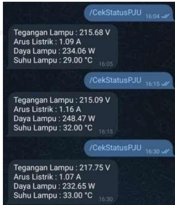
Gambar 4.10 Dokumentasi tampilan pada telegram untuk percobaan monitoring 1 lampu
