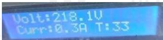
Gambar 4.13 Dokumentasi LCD yang tercatat pada percobaan monitoring 1 lampu
