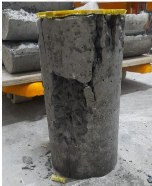
Gambar 5.11 Kerusakan Sampel Benda Uji Kuat Tekan
