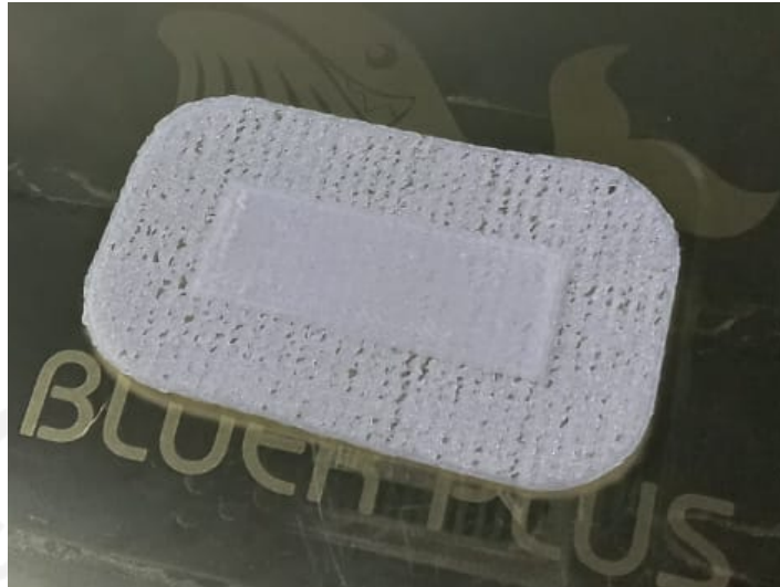
Gambar 4- 12 Terdapat Bagian Produk Yang Tidak Terisi Filamen
