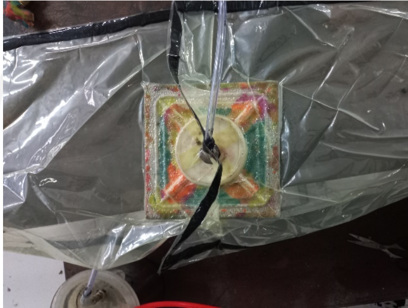
Gambar 4- 22 Percobaan Vacuum Infusion Dengan Menggunakan Vacuum Bag
