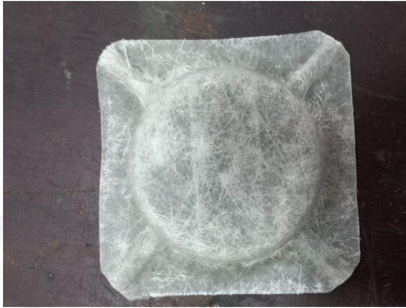
Gambar 4- 23 Produk Hasil Vacuum Infusion Dengan Penambahan Soft Mold
