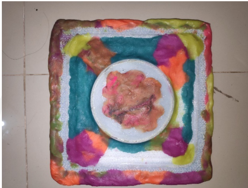
Gambar 4- 20 Soft Mold Dilapisi Plastisin Untuk Mengatasi Kebocoran
