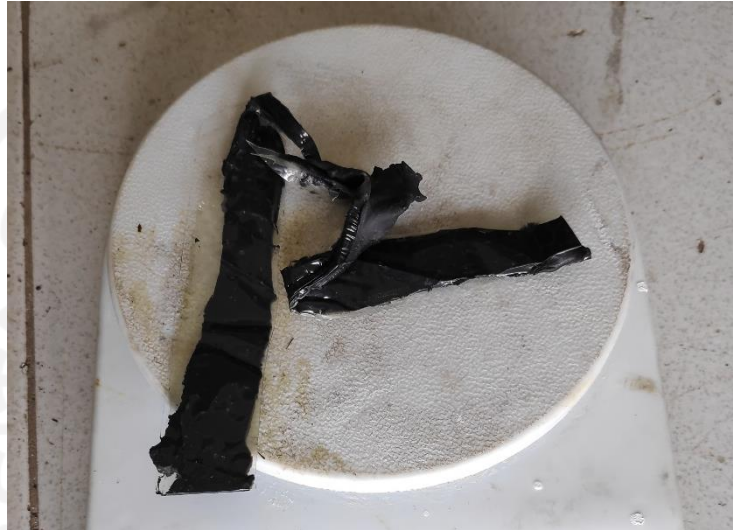
Gambar 4- 20 Limbah Vacuum Bag Pada VIP Dengan Soft Mold
