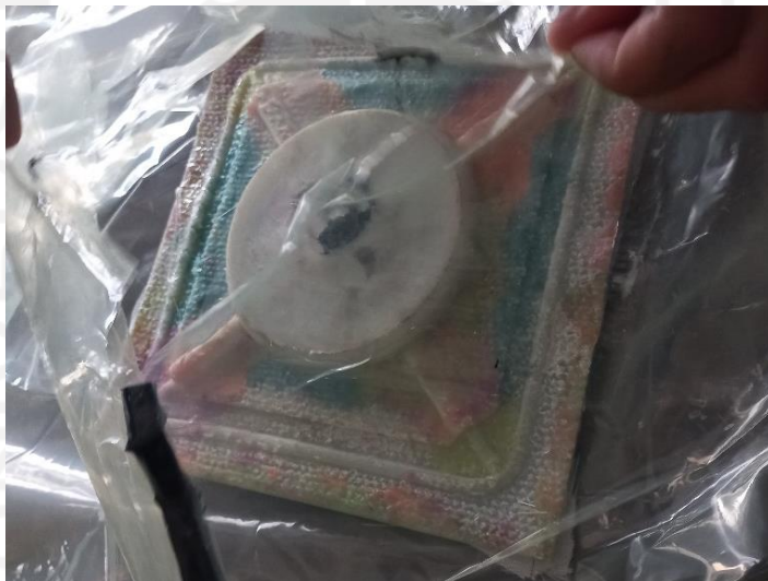
Gambar 4- 17 Plastik Tidak Menempel Pada Soft Mold
