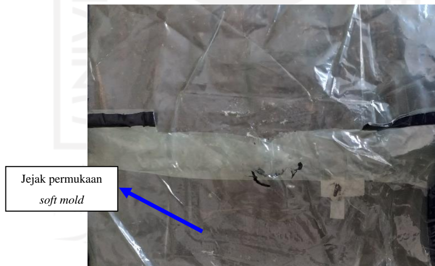
Gambar 4- 19 Kondisi Vacuum Bag Setelah VIP Menggunakan Soft Mold
