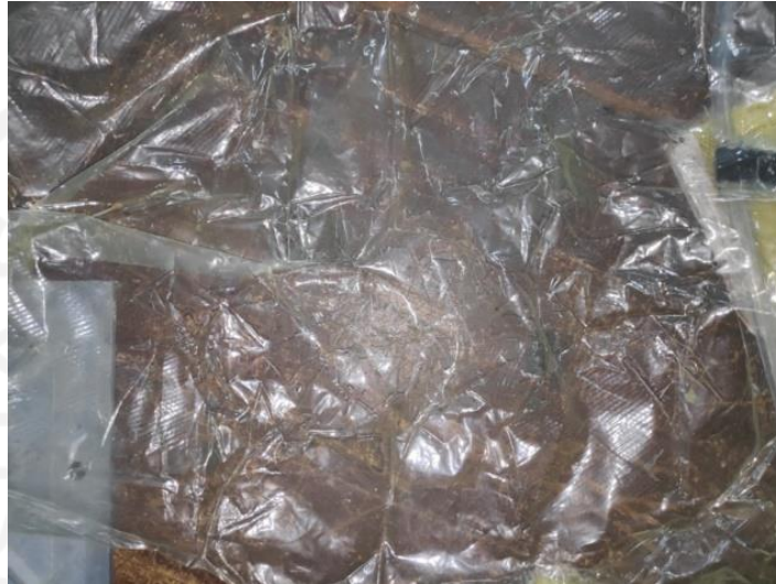
Gambar 4- 18 Kondisi Plastik Setelah Proses Vacuum Infusion Tanpa Soft Mold
