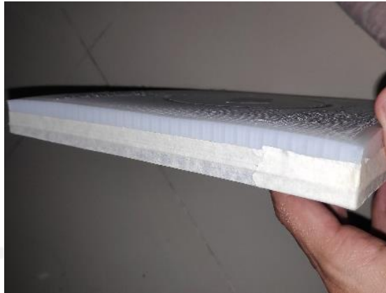
Gambar 4- 5 Penambahan Isolasi Kertas Pada Tepian Cetakan
