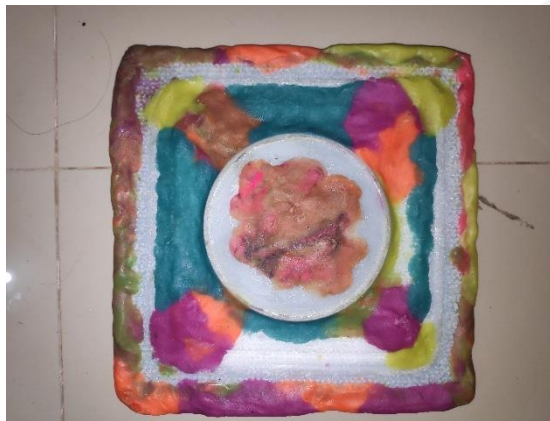
Gambar 4- 7 Soft Mold yang Ditambal Plastisin Pada Bagian yang Bocor
