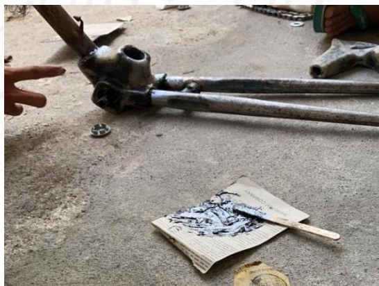
Gambar 4- 25 Proses pengeleman bracket dan pipa frame
