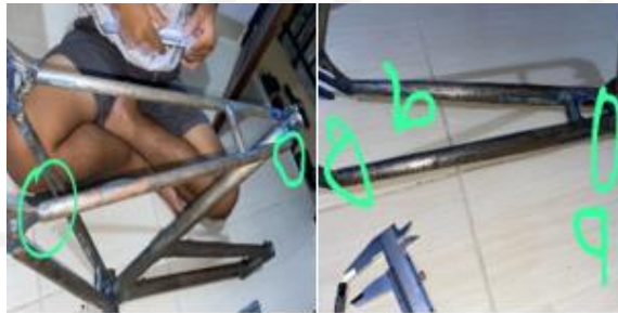
Gambar 4- 1 Proses pengukuran frame
