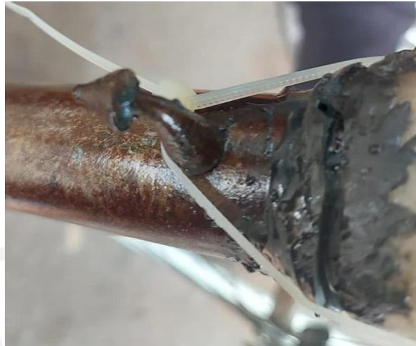
Gambar 4- 31 Lem lepas pada bagian head tube
