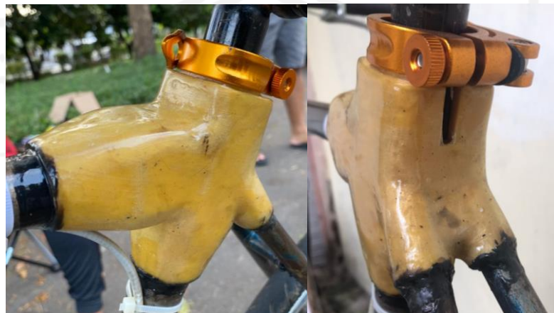
Gambar 4- 35 Kondisi bracket seatpost setelah pengujian jalan
