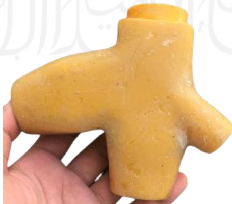
Gambar 4- 37 Bracket Seatpost berbahan PLA yang dilapisi Fiberglass
