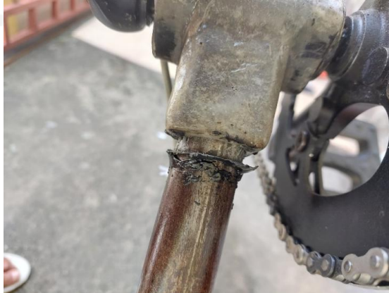
Gambar 4- 27 Penampakan lem terlepas pada bagian bottom bracket
