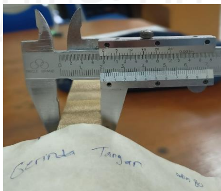
Gambar 4- 29 Ketebalan Talenan Hasil Pengamplasan Gerinda Tangan
