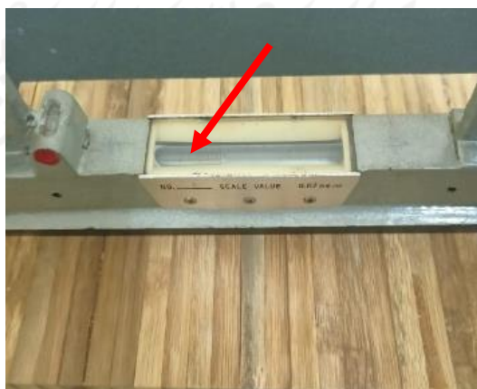
Gambar 4- 35 Kerataan Talenan Hasil Pengamplasan Gerinda Tangan
