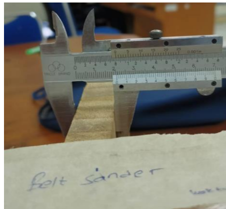
Gambar 4- 32 Ketebalan Talenan Hasil Pengamplasan Mesin Belt Sander
