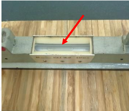
Gambar 4- 36 Kerataan Talenan Hasil Pengamplasan Mesin Belt Sander
