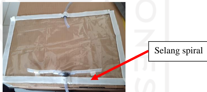
Gambar 4-3 Pemasangan Selang Spiral
