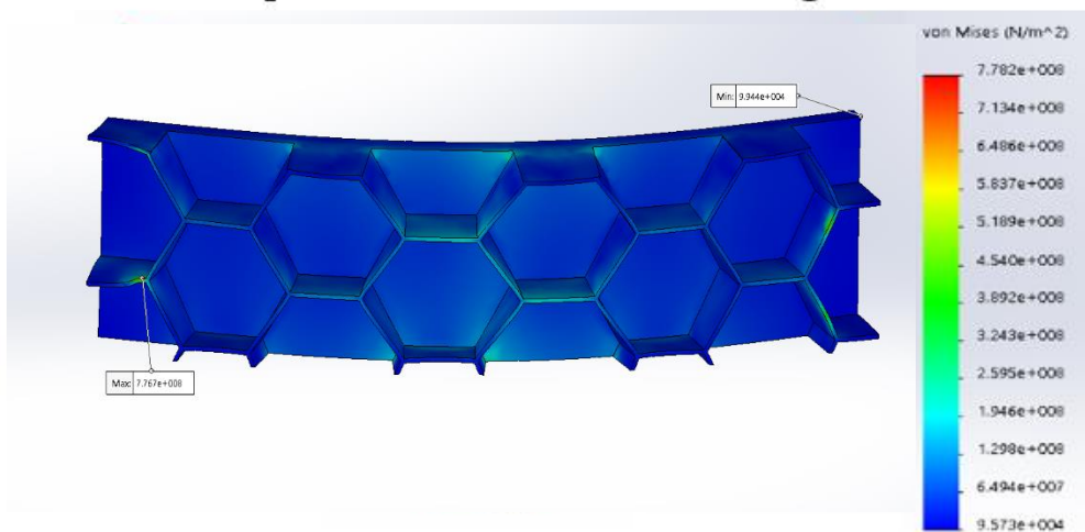
Gambar 4-30 Hasil Analisis Kegagalan Ribs Diameter 30 dan Tebal 1 mm
