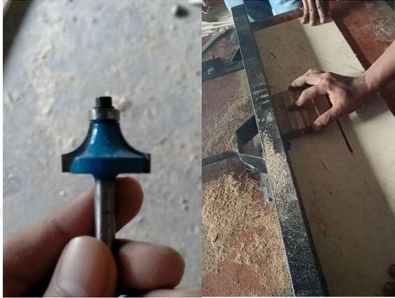
Gambar 4 - 38 Pengerjaan Menggunakan Mata Profil *Round Over*
