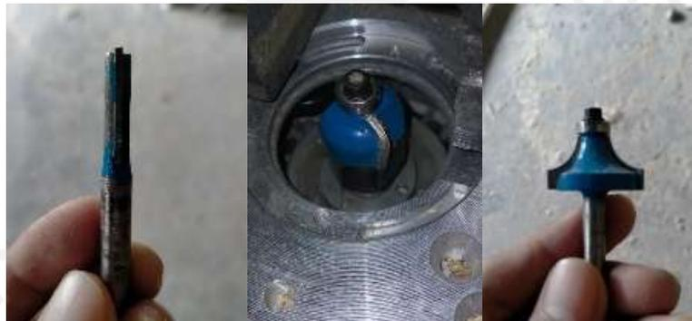
Gambar 4 - 3 Mata Mesin Profil *Stright Bit*, *Cove Bit* dan *Round Over*
