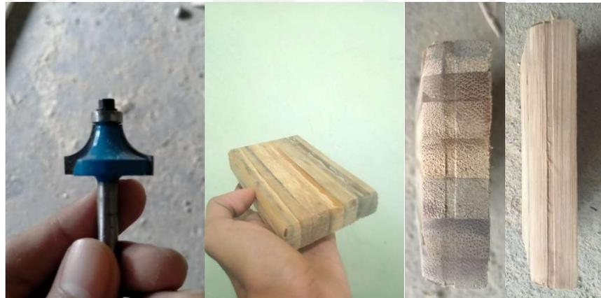
Gambar 4 - 39 Pengerjaan Menggunakan Mata Profil *Round Over*
