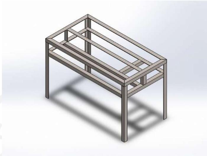
Gambar 4 - 13 Desain Rangka Dengan Besi Siku
