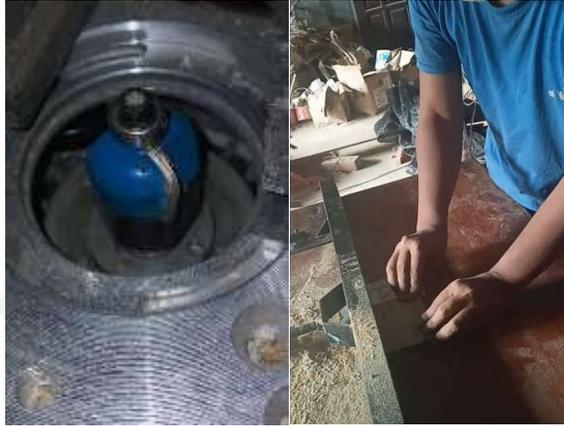
Gambar 4 - 34 Pengerjaan Menggunakan Mata Profil *Cove Bit*
