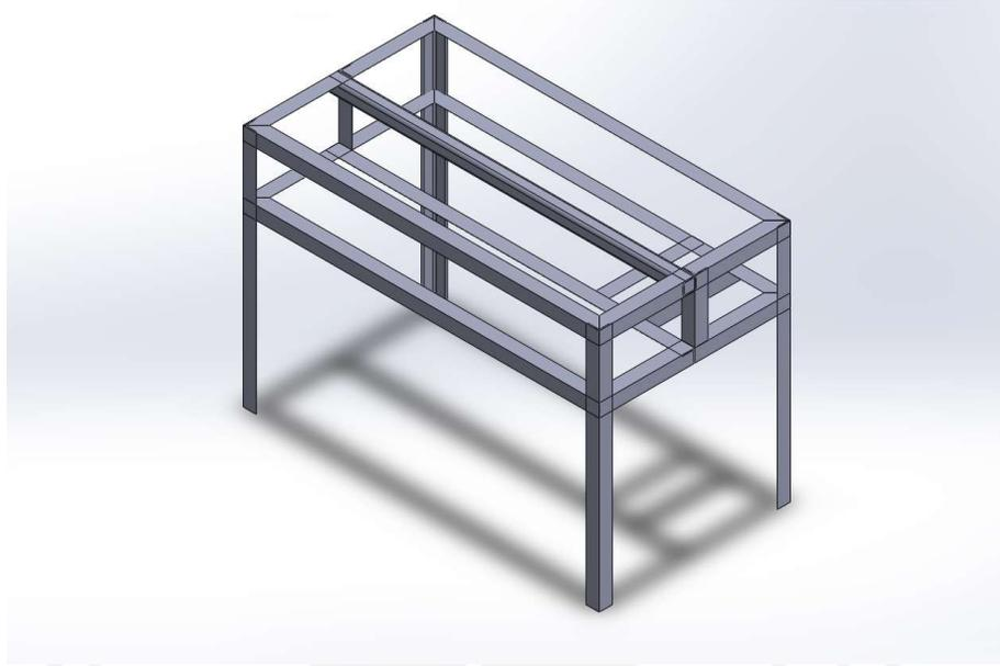
Gambar 4 - 17 Rangka Meja Mesin Profil
