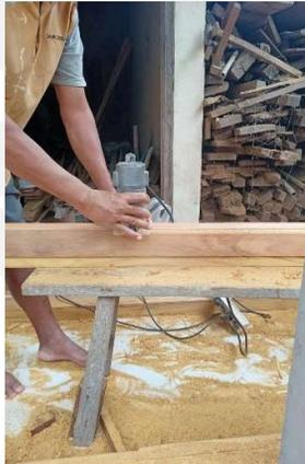
Gambar 1 - 1 Proses Permesinan Dengan Mesin Profil Tangan
