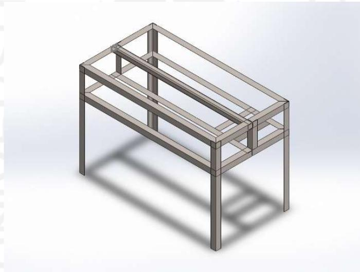
Gambar 4 - 14 Desain Rangka Dengan Besi Siku dan *Hollow*
