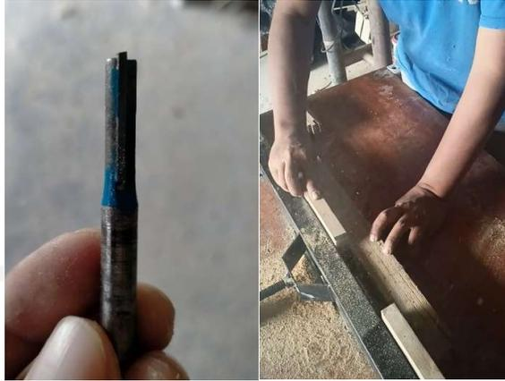
Gambar 4 - 36 Pengerjaan Menggunakan Mata Profil *Straight Bit*
