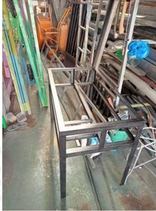
Gambar 4 - 24 Rangka Meja Mesin Profil
